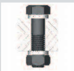
Bullone esagonale con foro passante, fissato su entrambi i lati
