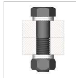
Bullone esagonale con foro passante, fissato su entrambi i lati
